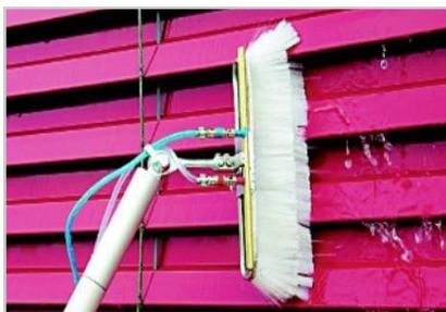
Einfaches Auftragen ab sicherem Boden von Algenbekämpfungsmittel oder ähnlichem auf Fassaden und Dächern.
